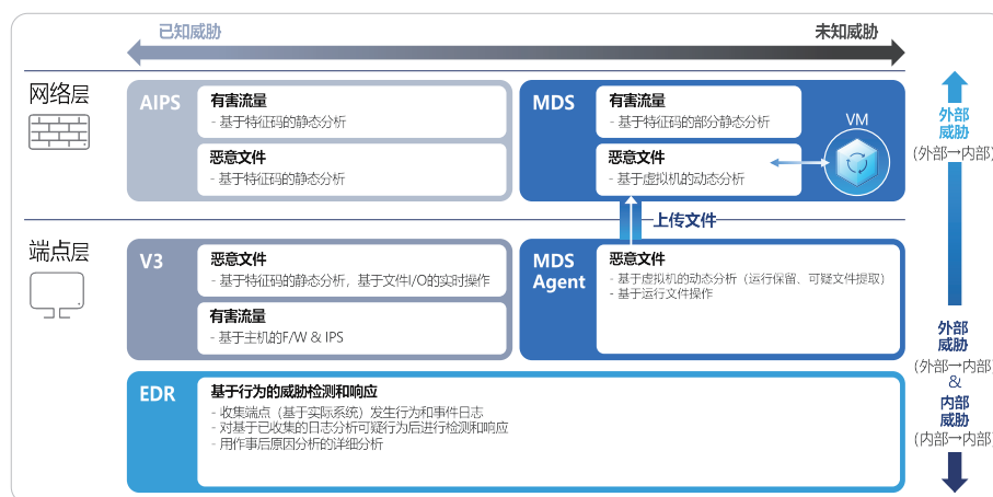
[图7] 基于端点统一Agent的威胁响应架构
